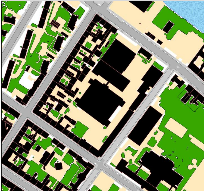
Abbildung II-4: Erweiterte Versickerungspotenzialkarte mit den Restriktionsflächen Straßenflächen (grau) sowie Hof- und Wegeflächen (beige)
