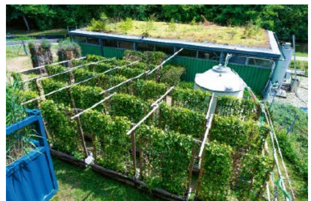
Abb. 1: Versuchsstand zur Erfassung/Speicherung von Dachablaufwasser und Bewässerung von Fassadenbegrünungselementen (Bildquellen: ISWA Stuttgart)
